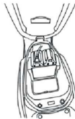
3. Kabelanschluss für die Stromversorgung
